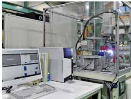
▲刃物の状態を確認する装置。ベテラン従業員の思考を組み込み解析する。仕事を重ねるほどに学習し精度が上がる。
